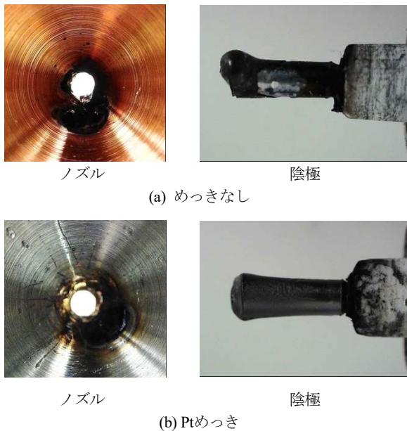
図2 プラズマトーチ作動後のノズルと陰極 (DME流量3 L/min, 放電電流25 A, 1 min作動)
